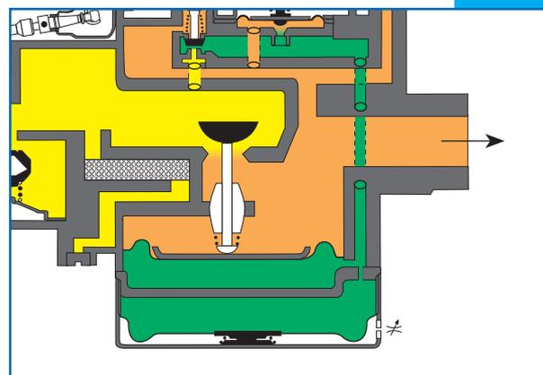
Ensuite la pression augmente rapidement et le clapet s'ouvre jusqu'à sa position nominale.
