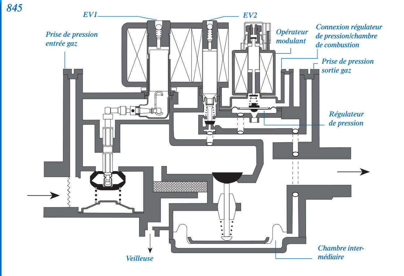
845 SIGMA dispose de deux électrovannes de sécurité pour le contrôle du débit gaz.
